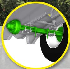
**Tren de rodaje atornillado para ajustar la distribución de las cargas al colocar un útil trasero**
