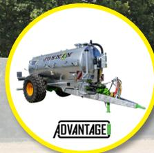
**Advantage 10 000 I: ruedas 650/65R26.5, bomba MEC 8 000 l/min, Ecopump, pre-equipamiento para útiles de esparcimiento...**
