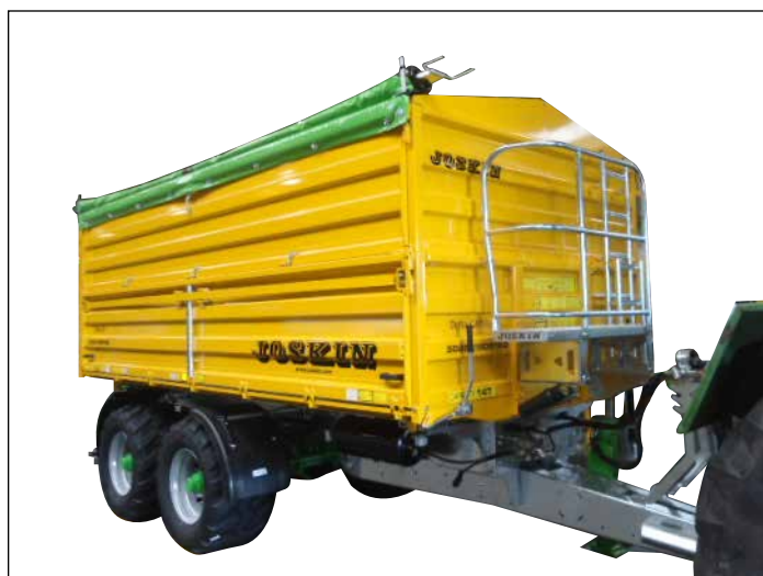
Seitenwanderhöhen aus geschlossenen Profilblechen
