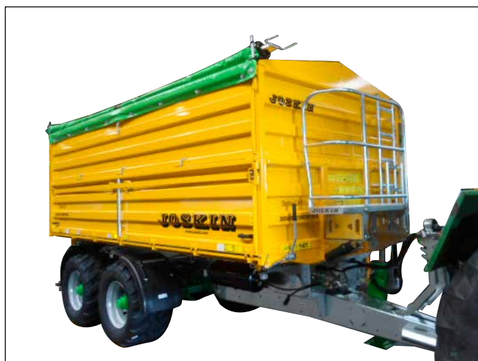
Opzetschotten in gesloten profielen
