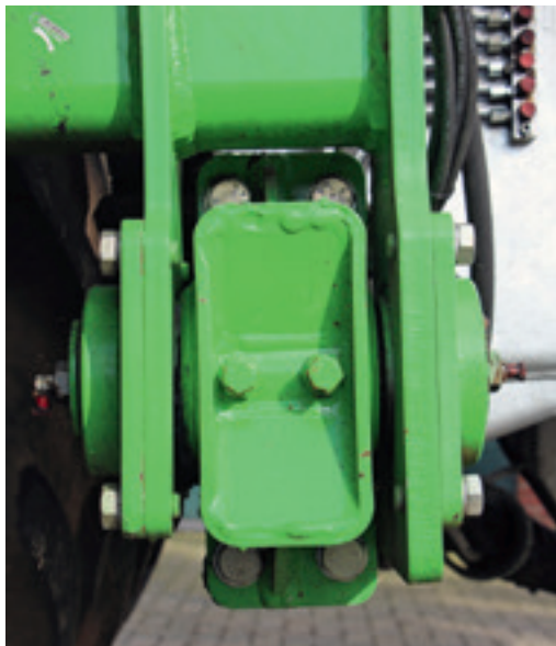
Bij panne of versleten banden, kunnen beide wielparen met vier bouten vooraan en vier bouten achteraan gedemonteerd worden. Op de foto de koppen van de vier bouten aan de voorzijde.
