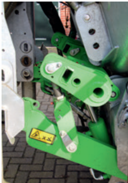
De geïntegreerde vierpuntheftinrichting van de TetraX2 is kort en compact zodat de bemesters dicht op de tank zitten en voldoende oplegdruk resteert.
