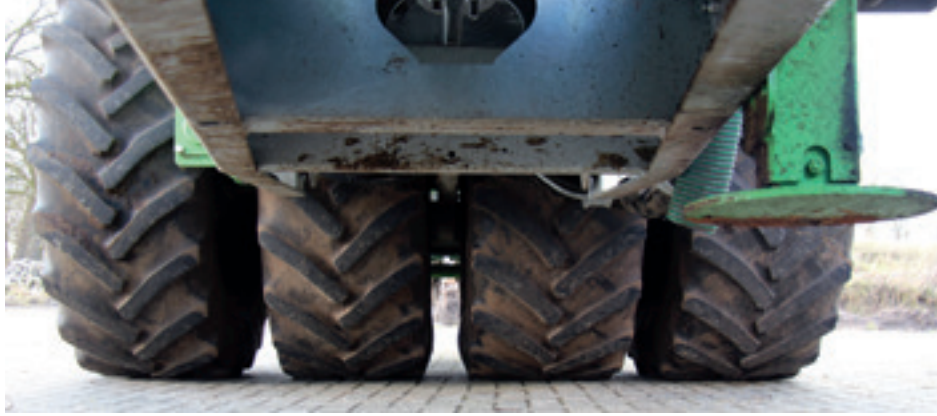
Hét kenmerk van de Joskin TetraX mengmesttanks zijn de vier wielen op één lijn. Ze zijn in twee paren dwars op de rijrichting pendelend opgehangen.
