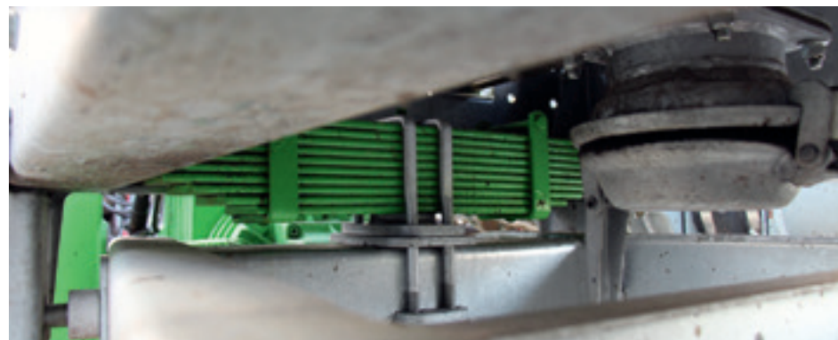
Volgens gebruikers doet het flinke verenpakket goed zijn werk en draagt het bij aan een stabiel weggedrag, vol en leeg. Optioneel is een hydropneumatische vering leverbaar.
