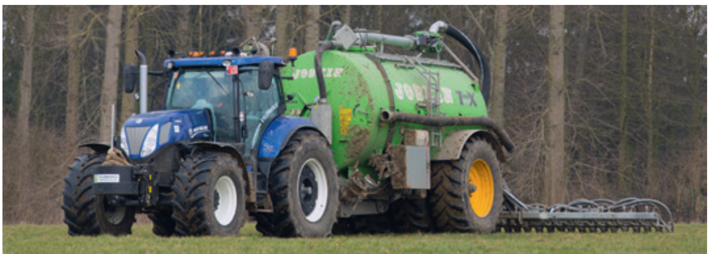
Volgens gebruikers doet het flinke verenpakket goed zijn werk en draagt het bij aan een stabiel weggedrag, vol en leeg. Optioneel is een hydropneumatische vering leverbaar.
