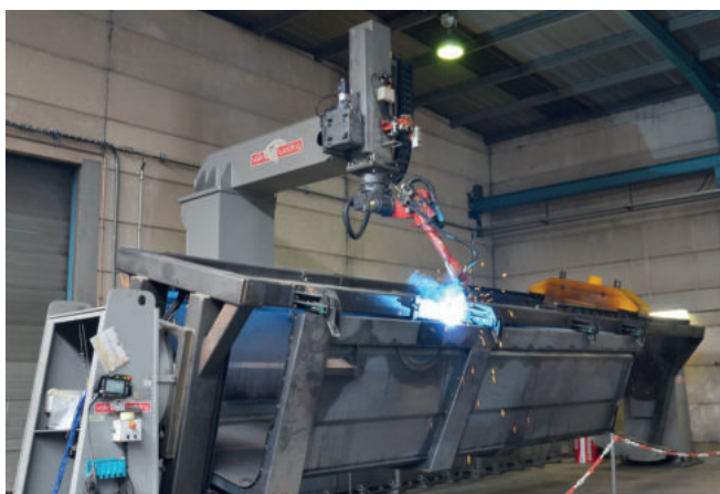
Кузов монолитного прицепа на стенде, свариваемый роботом
