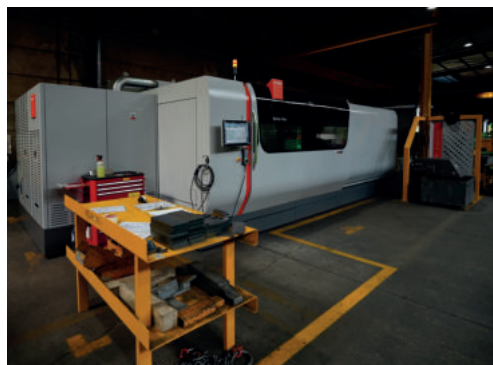
Платформа лазерной резки с оптическим волокном с высокой скоростью операции и минимальным нагревом для снижения деформаций
