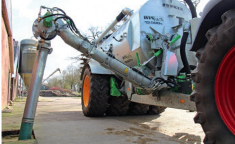
Le bras d'aspiration optionnel avec remplissage turbo en option permet de remplir la cuve de 13 m<sup>3</sup> en deux minutes.
