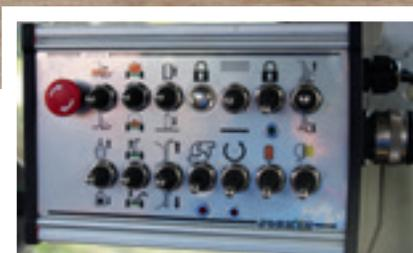
Le boîtier de commande est simple et facile à utiliser. Joskin l'a baptisée « boîtier de commande électrohydraulique multifonction ».
