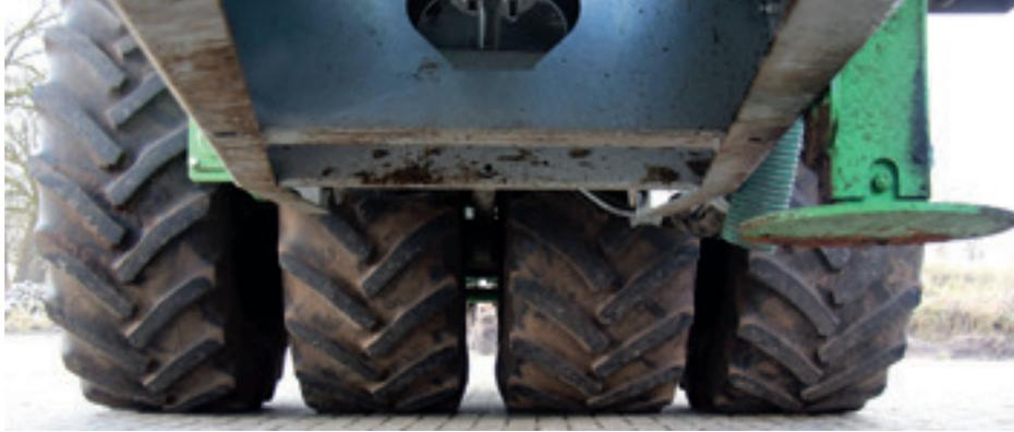
*Les épandeurs de lisier Joskin TetraX se caractérisent par leurs quatre roues alignées. Elles sont montées en deux paires avec un dispositif pendulaire transversal par rapport au sens de la marche.*
