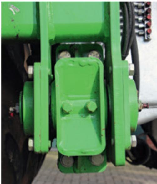
*En cas de panne ou de crevaison, les deux paires de roues peuvent être démontées avec quatre boulons à l'avant et quatre boulons à l'arrière. La photo représente la tête des quatre boulons à l'avant.*
