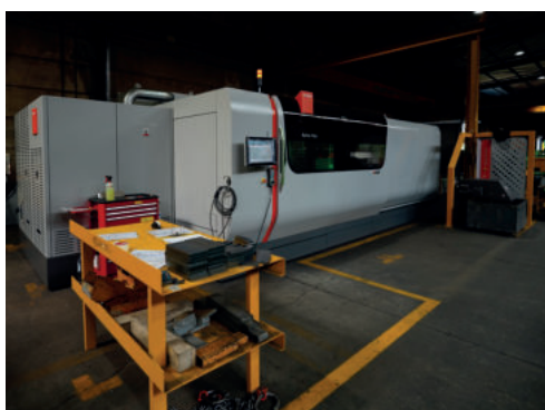
15-kW-Faserlaser für ultraschnelles Blechschneiden mit minimaler Erwärmung zur Minimierung von Verformungen
