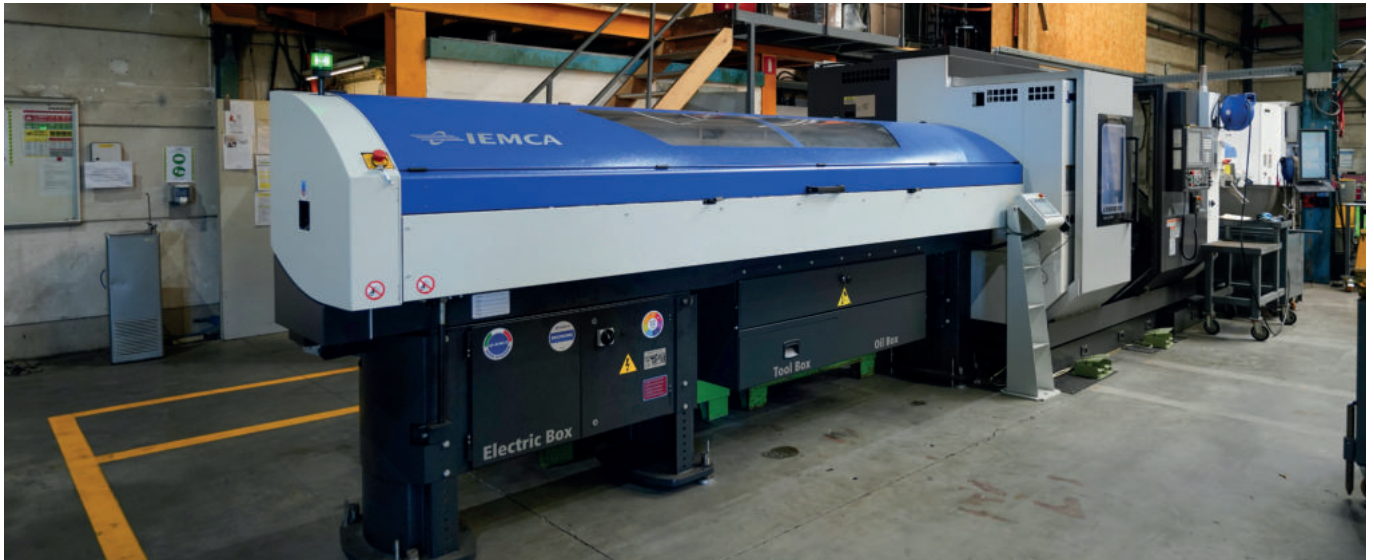
Numerisch gesteuerte Drehmaschine mit Stangenvorschub und automatischer Ausgabe
