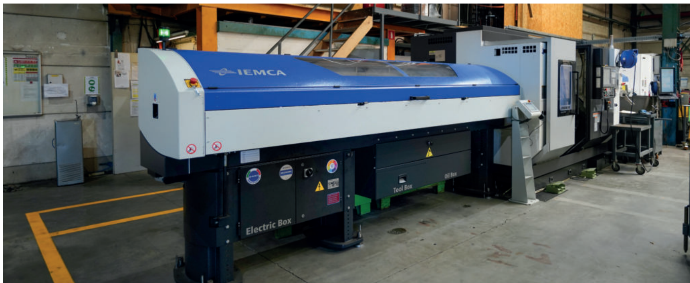
Torno de control numérico equipado con un alimentador de barras y una salida automática
