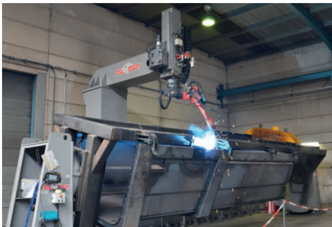
Caja de bañera monocasco fijada en una plantilla giratoria y soldada por un robot
