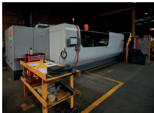
Láser de fibra de 15 kW para el corte ultrarrápido de chapa con una mínima acumulación de calor para minimizar la distorsión
