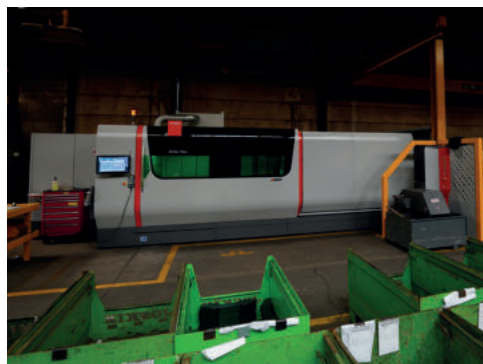
Láser de fibra de 15 kW para el corte ultrarrápido de chapa con una mínima acumulación de calor para minimizar la distorsión
