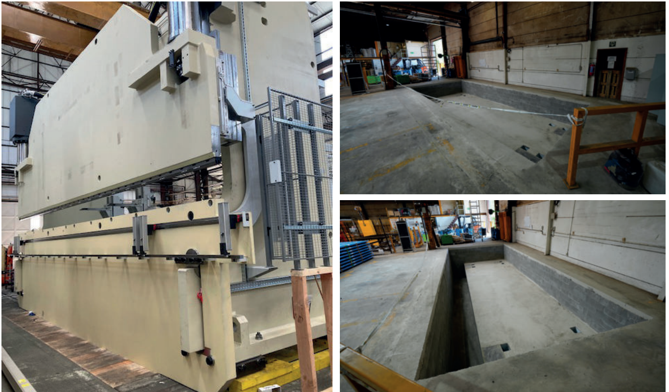
Nueva prensa plegadora montada en el proveedor (izquierda) y su futura ubicación en la fábrica (derecha)
