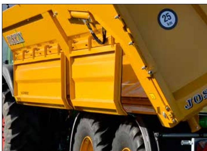
Blacha zabezpiecza koła podczas bocznego wyladunku
