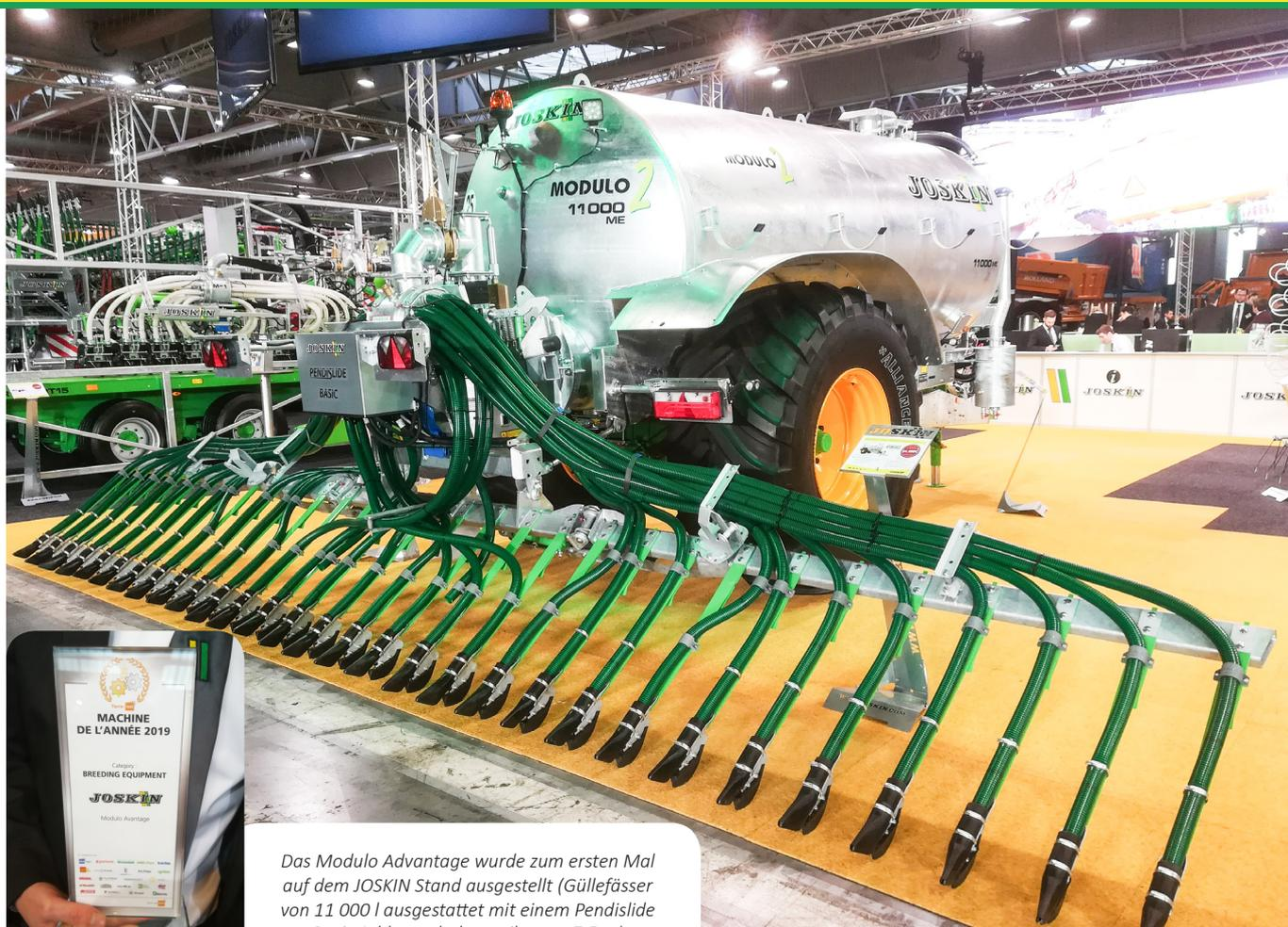
*Das Modulo Advantage wurde zum ersten Mal auf dem JOSKIN Stand ausgestellt (Güllefässer von 11 000 l ausgestattet mit einem Pendslide Basic Schleppschuhverteiler von 7,5 m)*
